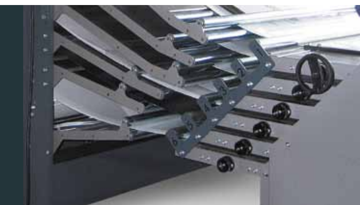
Automatická výmena zvitku za menej ako minútu od jedného až do osem zvitkov
