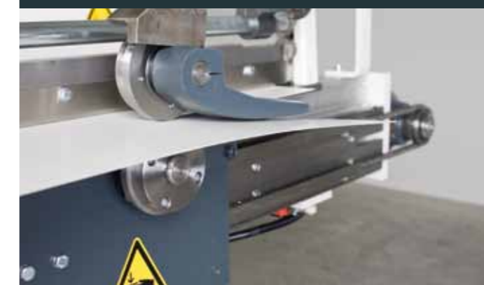
Priečne delenie s ručnými/elektrickými nožmi alebo tabuľové nožnice a prídavné funkcie ako napríklad navíjanie na zvitok
